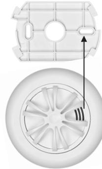
Drehen Sie den Melder im Uhrzeigersinn, bis er einrastet. Eine Sperre [9] verhindert das Zudrehen des Melders, wenn die Batterien fehlen bzw. nicht ordnungsgemäß eingelegt sind.
