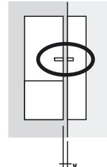
3. La distanza y (vedi Fig. destro) tra il magnete e il sensore non deve superare i 2 cm. Per controllare la distanza tirando il magnete e il sensore lentamente a parte. Finché il LED del sensore quando si tira non lampeggiare blu è la distanza in ordine. Una volta che lampeggia, la distanza è troppo grande. Controllare la distanza nello stesso modo spingendo insieme e mantenere la distanza sicuramente il più basso possibile.
