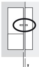
3. Der Abstand y (siehe Abb. rechts) zwischen Magnet und Sensor darf maximal ca. 2 cm betragen. Zum Überprüfen des Abstandes ziehen Sie Magnet und Sensor langsam auseinander. So lange die LED des Sensors beim Auseinanderziehen nicht blau blinkt, ist der Abstand in Ordnung. Sobald sie blinkt, ist der Abstand zu groß.
